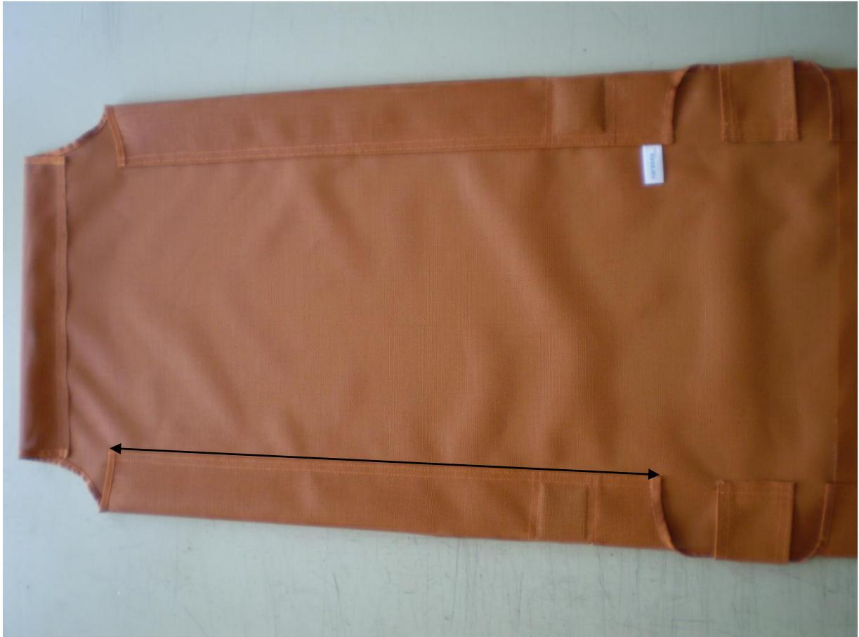
Abbildung 1 BGL Bespannung altes Mod. : ↔ = 63 cm
